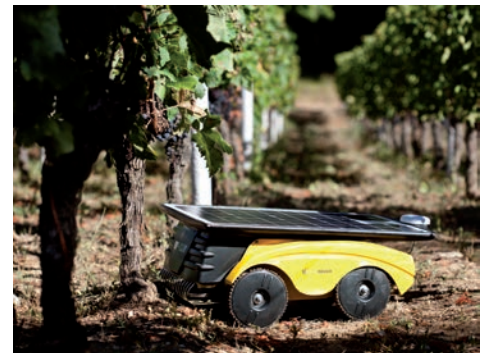
Le Vitirover est piloté par une application pour smartphone. — La panneau solaire permet une certaine autonomie au robot.
